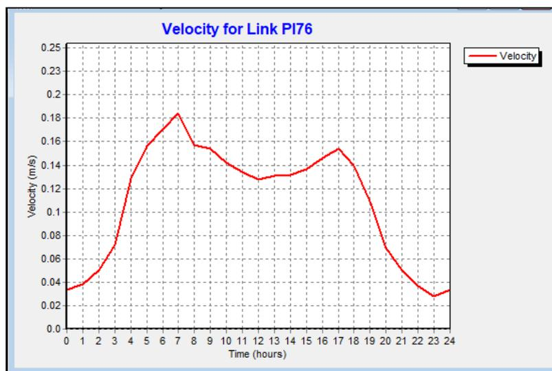
**Gambar 7.** Kondisi Kecepatan pada pipa pelayanan terjauh
