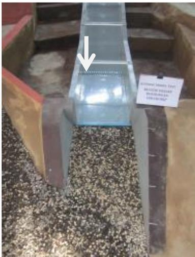
**Gambar 9. Kondisi peredam energi di model fisik hidraulik**
