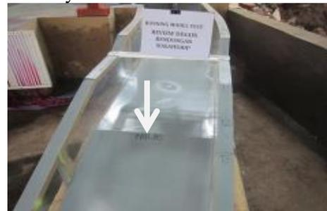
**Gambar 7. Kondisi saluran transisi di model fisik hidraulik**
